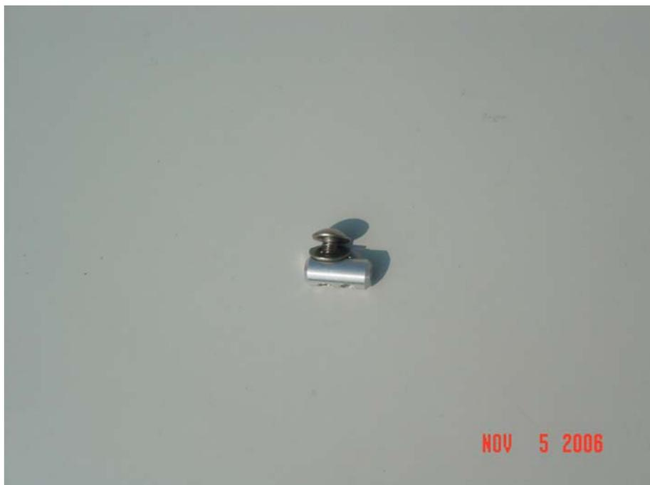
この写真は、細タイプのストッパーです。六角ボルト×1箇所+タッピングねじ×1箇所で固定する仕様となっています。
