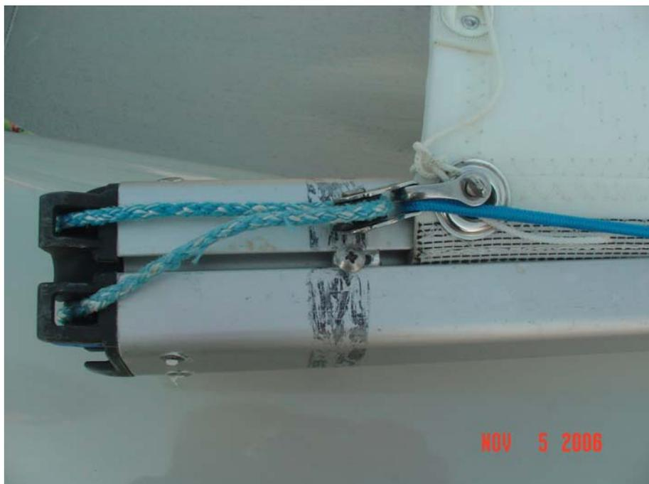
この写真は、別の艇の例です。プロクターブームに細タイプのストッパーを用いています。セールのボルトロープ形状およびセールの変形を考慮し、ストッパー固定位置をブラックバンドよりも前にオフセットしている点にも注目して下さい。
